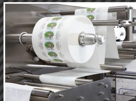
Albero portabobina ad espansione interna con regolazione fine della centratura della bobina e freno di compensazione.
