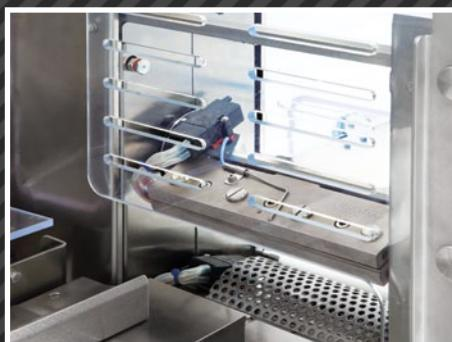
Gruppo di saldatura trasversale in acciaio forgiato.
