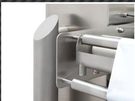
Struttura a sbalzo in AISI 304 con sostegno perimetrale indipendente, compatta, robusta, facilmente ispezionabile, perfettamente igienizzabile.
