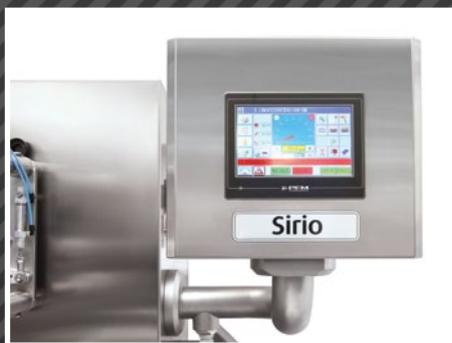
Macchina servoassistita con 3 motori *brushless* controllati tramite pannello tattile H.M.I. ad alta definizione e software semplice.
