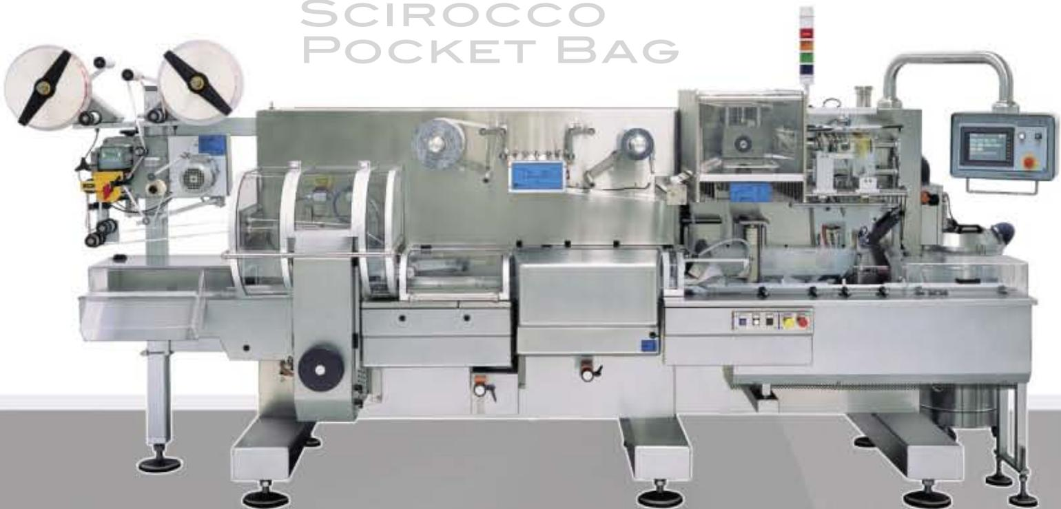
• **Evoluzione tecnologica ai massimi livelli:** top design per esigenze specifiche di alta produttività. Alberi portabobina ad espansione, freni a disco controllati elettronicamente, perfetto riciclo del gas all'interno del tubolare di film particolarmente lungo. Gruppo di saldatura Long Dwell - HS 1-2-3-4 ganasce per albero (brev. PFM) fino a 200 ppm. Gruppo ruote di saldatura separato e inclinabile montato a sbalzo e regolabile in altezza.
