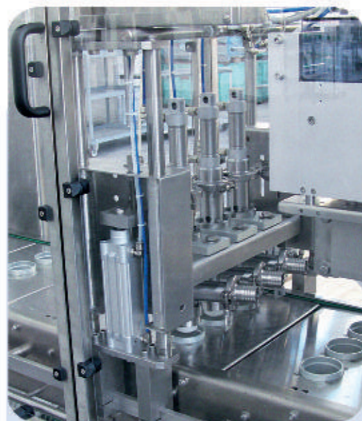
Stazione di dosaggio / Doser unit.
