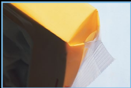
Particolare della saldatura a soffietto. Detail of end seal with gusset tucking.
