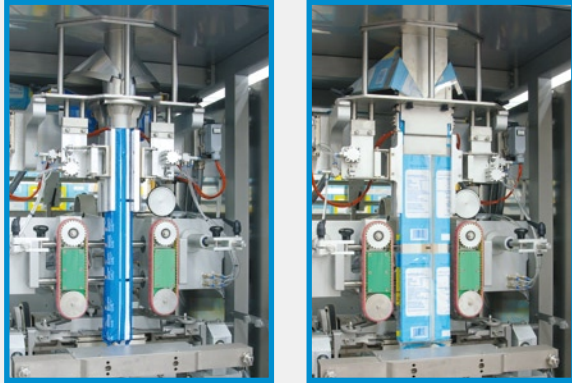
Particolare di due tubi conformatori. Detail of two forming tubes.
