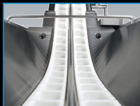
• Particolare del nastro di carico ad alveoli. • Detail of the elevator.
