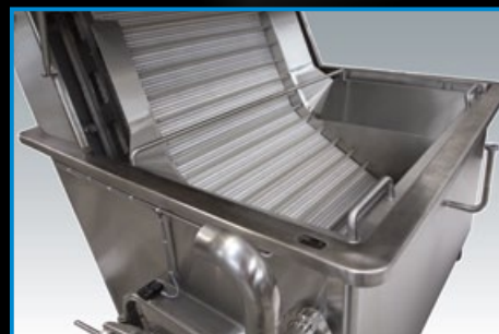
• Particolare del nastro di carico con bagno di liquido di governo. • Detail of the infeed conveyor with preserving liquid bath.
